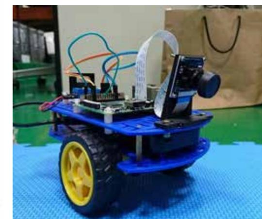
了如影像處理與馬達的控制系統，為了使 ROS 的架構也能引入 Xenomai 的即時能力，導入 Orocos 的 RTT，實作自走車來驗證即時作業系統。
